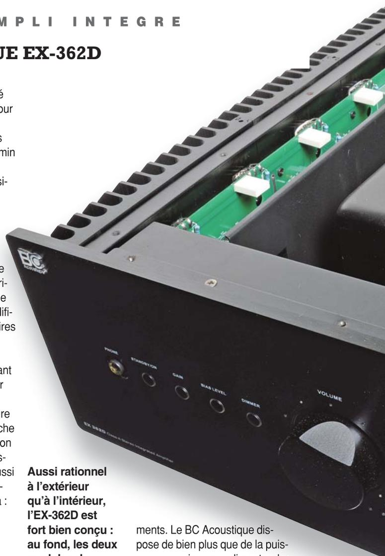
**Aussi rationnel à l'extérieur qu'à l'intérieur, l'EX-362D est fort bien conçu : au fond, les deux modules du préamplificateur, le transformateur des étages de puissance et devant lui (non visible), celui du préampli. Les quintuples push-pull par canal sont montés sur de larges dissipateurs latéraux.**
