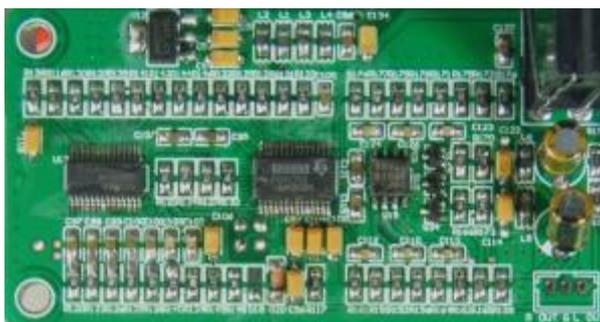
Sur la vue ci-dessous on peut voir **les relais de commutation des entrées** ainsi que les sorties symétriques sur prises XLR avec leurs circuits de symétrisation faisant usage de deux amplificateurs opérationnel NJM5532, tout comme les sorties Pre et Sub, celles-ci délivrant un signal correspondant à la somme des signaux des voies droite et gauche.
