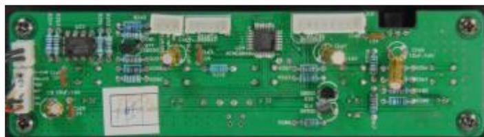
Ci-dessous, une vue de la carte regroupant la **pré amplification et le contrôle des graves et des aigus**, ces fonctions étant réalisées par des montages à base d'amplificateurs opérationnels NJM5532 fabriqués par la New Japan Radio Company (JRC). On remarquera aussi la présence de condensateurs électrochimiques Nichicon Gold et de modèles à couches plastique.
