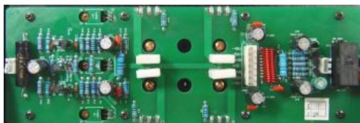
Un circuit de temporisation prend également place sur chaque platine d'amplification à côté du relais des enceintes afin d'éviter les très désagréables (et néfastes) clics dans celles-ci à la mise sous tension.
