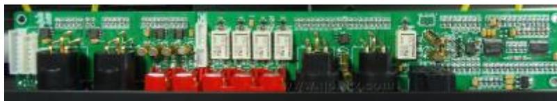
**L'interface avec les entrées numériques S/PDIF** est confiée à un circuit Cirrus Logic CS8416 (24 bits à 192 kHz) et la conversion numériques analogique est réalisée par une puce Burr-Brown PCM1793 (24 bits à 192 kHz également). Les signaux sont ensuite nettoyés par un filtre actif construit autour d'un amplificateur opérationnel NJM5532 fabriqué par JRC.
