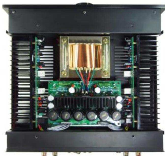
Ce transformateur est un modèle traditionnel réalisé avec un grand soin, on note ainsi que les enroulements sont imprégnés de vernis et qu'un feuillard de cuivre les ceinture afin de faire obstacle aux fuites de rayonnement, tandis que sa fixation sur le fond du boîtier se fait par quatre solides tiges filetées bloquées par des écrous borgnes (un sens du détail appréciable).
