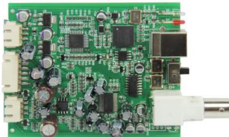
**L'interface S/PDIF** est confiée à un circuit Cirrus Logic CS8422 (24 bits à 192 kHz, monté sur l'autre face du circuit) et la conversion numérique analogique est assurée par un circuit CS4398 du même fabricant. C'est un circuit 74HC157 qui commute vers le CS4398 les signaux I2S provenant de l'USB ou du CS8422.
