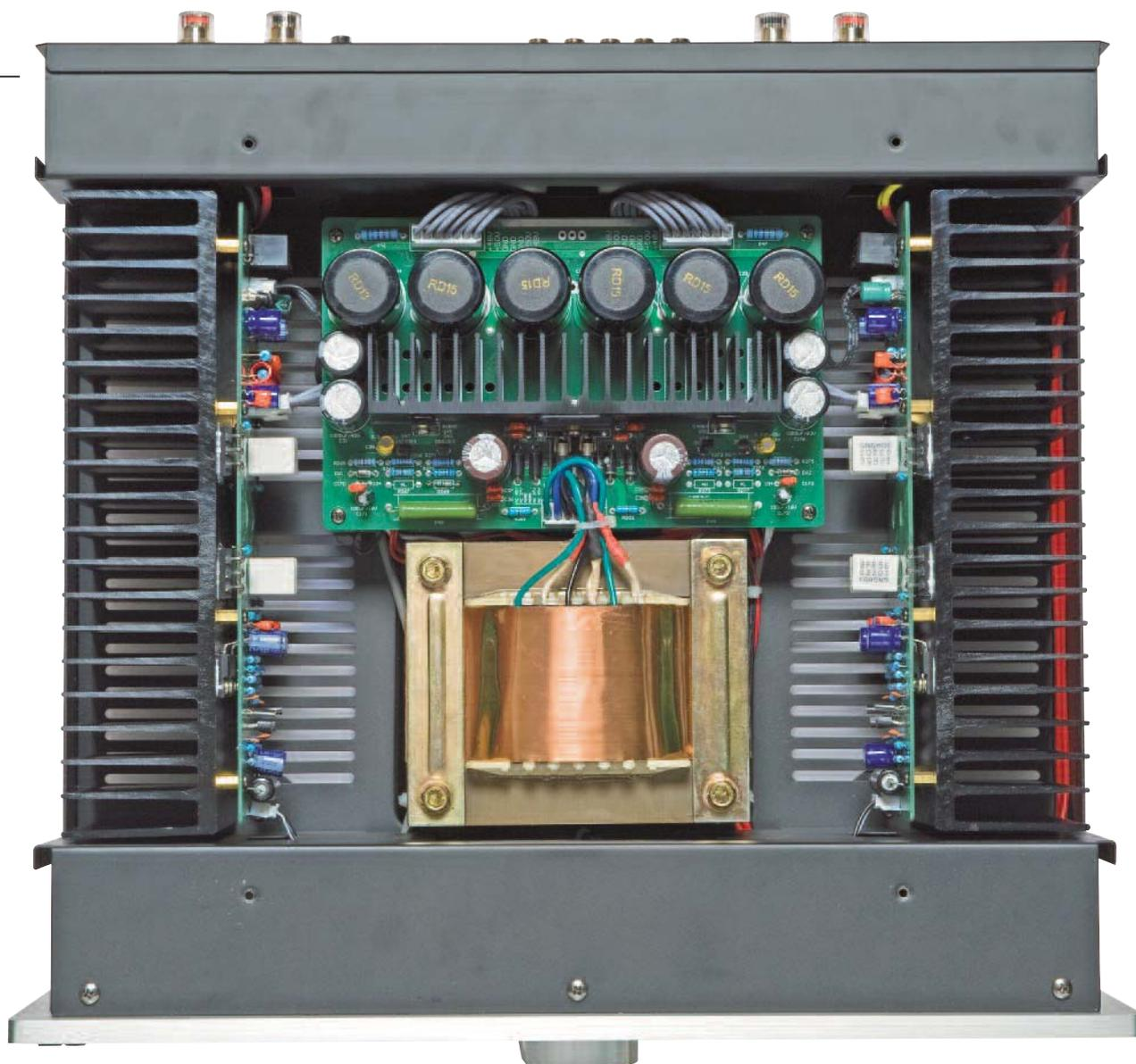
**Une disposition rationnelle et symétrique. Les étages de gain sont montés sur les dissipateurs latéraux. Au centre, le transformateur de 700 VA.**
