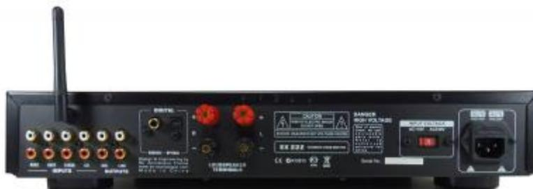
On notera que le porte fusible est intégré à l'embase secteur, ce qui est une bonne chose pour l'utilisateur et sa sécurité si ce fusible doit être changé après un incident. Mais attention, on doit toujours remplacer un fusible par un modèle de même intensité et de même réactivité (rapide ou retardé).
