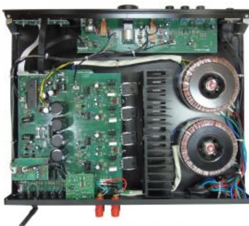
On notera aussi que, dans la mesure où il n'est pas nécessaire de miniaturiser, l'emploi de composants classiques (dit "traversants") est un indéniable avantage en cas d'une éventuelle panne, ceux-ci se remplaçant beaucoup plus aisément que leurs homologues à montage en surface.
