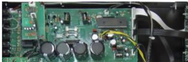
C'est également à partir de ces enroulements, mais en redressement "mono alternance" (une demi sinusoïde) qu'est réalisée la tension de +5V destinée au micro contrôleur SyncMos SM8952A (le gros circuit intégré dans la partie droite de la photo) et la tension de +12V alimentant les relais de commutation des sources (à gauche, un seul étant visible, les autres se trouvant cachés par la carte Bluetooth).
