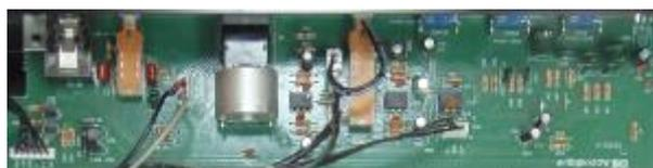
Tous les amplificateurs opérationnels utilisés, y compris pour l'amplificateur casque, sont des modèles à faible bruit NJM4580 du fabricant JRC (Japan Radio Company).
